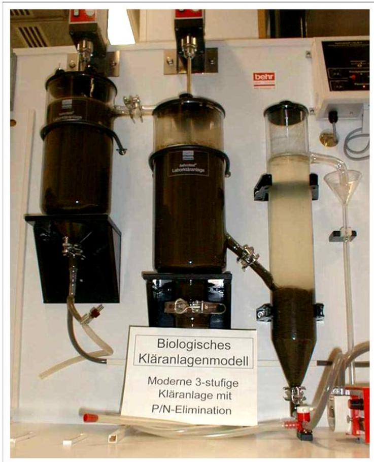
Abbildung 11: Beispiel eines Kläranlagen-Simulationstests.
