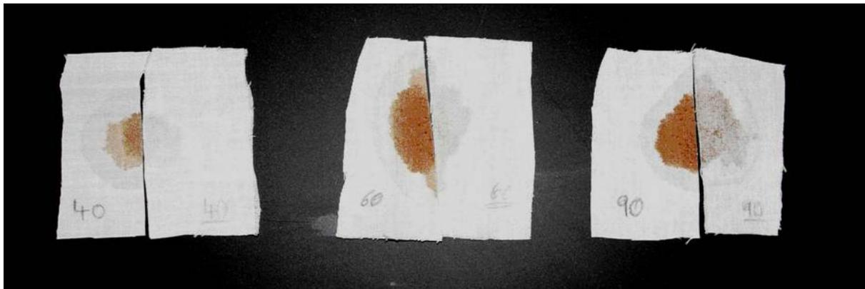
Abbildung 1: Waschergebnis von links bei 40 °C, 60 °C, 90 °C nach 40 Minuten
