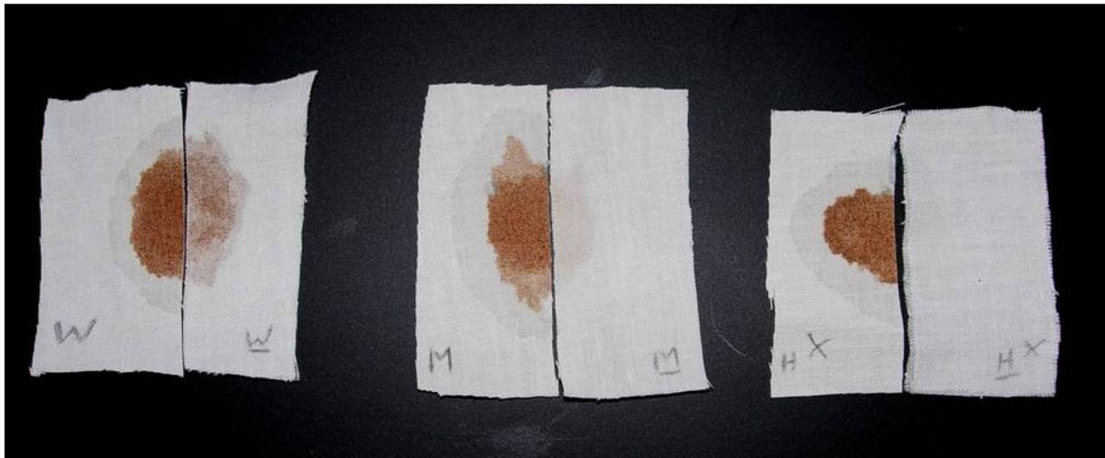
Abbildung 3: Waschergebnis von links: Dosierungen für weiches, mittel hartes und hartes Wasser; bei 40 °C, 40 Minuten mit hartem Leitungswasser
